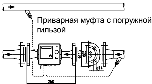
Пример монтажа теплосчетчика с фланцевым соединением
