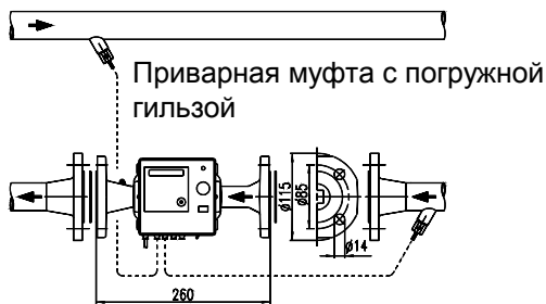
Пример монтажа теплосчетчика с фланцевым соединением
