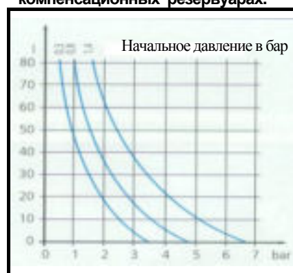
Рис. 6. Кривые давление-объем для ряда значений начального давления в компенсационных резервуарах.
