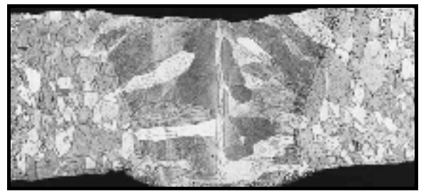
Рис 3: Микро снимок сварного шва гофрированной медной оболочки
