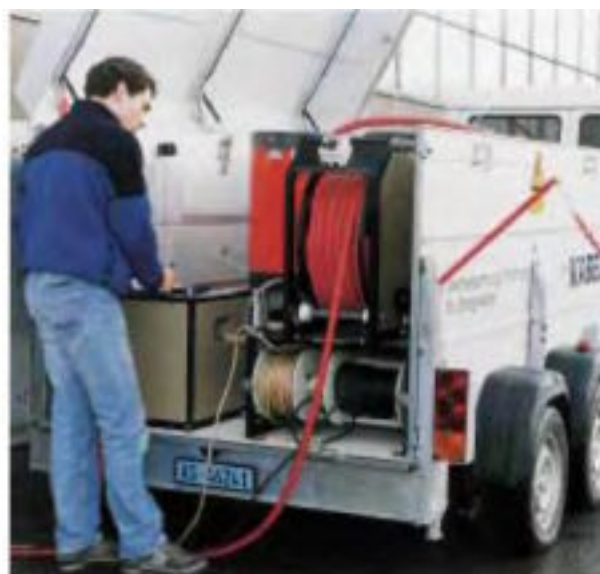
Рис. 6: Устройство для резонансных испытаний переменным током
