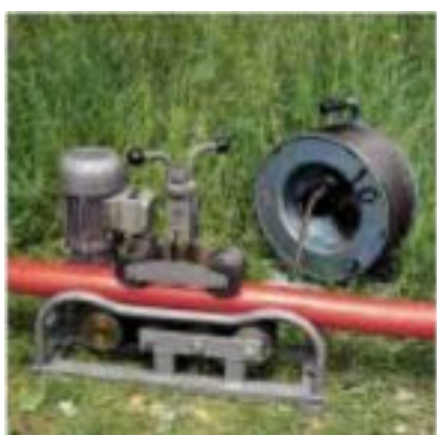
Ролики с электроприводом для протягивания кабеля
